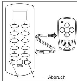
2. Halten Sie die Taste 2 des Multikanalsenders gedrückt bis die Anzeige im Display blinkt.
