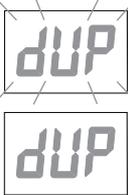
3. Drücken Sie innerhalb von 10 Sekunden am Quellsender kurz die Taste 0 und gleich anschließend die ENTER-Taste. Die ENTER-Taste des Zielsenders können Sie jetzt loslassen. Die Übertragung der Codes dauert ca. 70 Sekunden und wird im Display beider Sender angezeigt.
